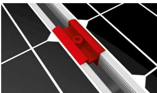
Entre deux modules utiliser deux étriers intermédiaires universels OneMid. Clipser l'étrier dans la rainure du rail et fixer l'étrier au cadre du module.
