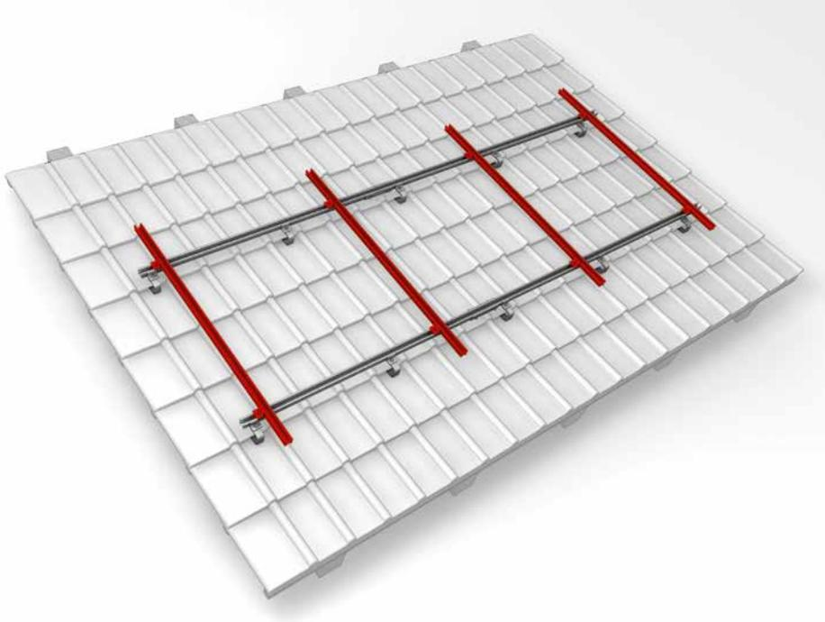
La rangée supérieure de rails (montage en croix) est fixée à l'emplacement souhaité et avec un intervalle adapté à l'aide de l'écrou prisonnier M K2 et le Kit Climber.
