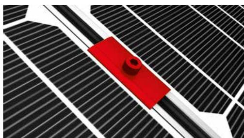
Alternative: Entre deux modules, utiliser deux étriers intermédiaires XS qui doivent également être vissés sur les écrous prisonniers avec des vis DIN 912 M8.
