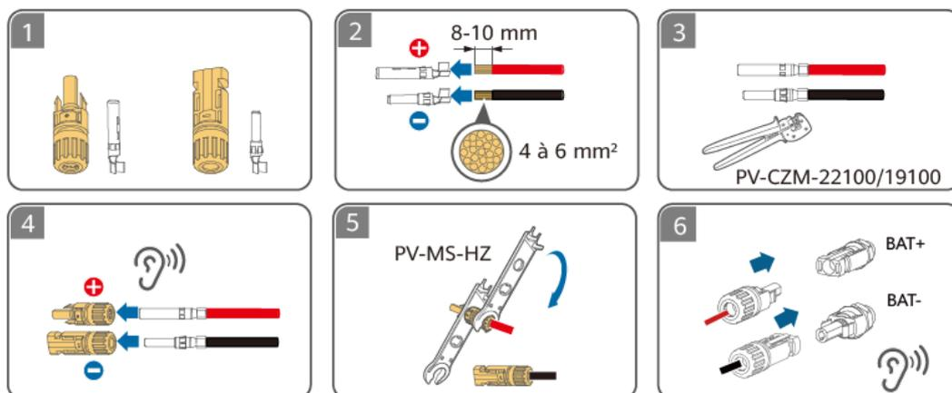
Dans un système en parallèle, connectez les câbles d'alimentation CC entre les ESS en vous référant aux connexions de câbles entre l'onduleur et un ESS.
