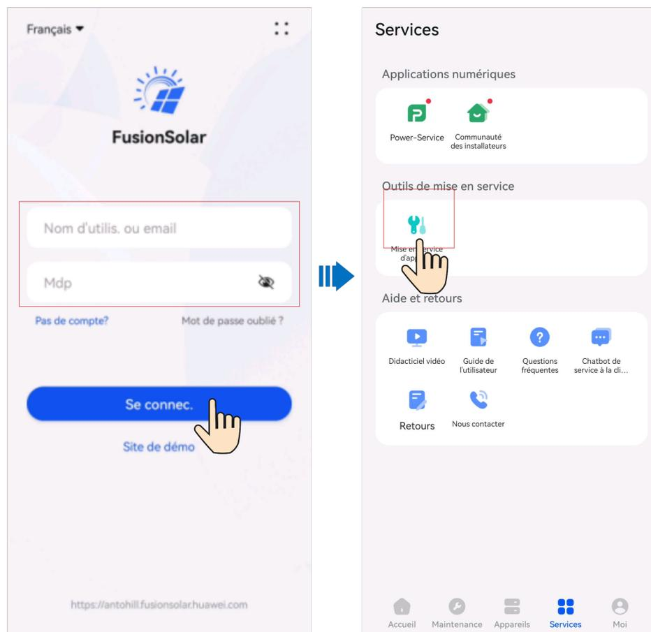
**Étape 2** Connectez-vous à l'onduleur solaire WLAN en tant qu'**installateur** pour accéder à l'écran Mise en service de l'appareil.
