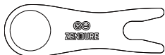
Clé pour retirer les connecteurs PV et les connecteurs de câble AC
