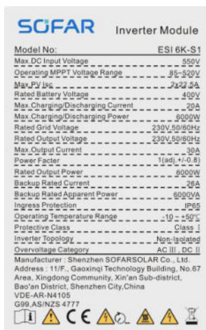
Figure 2.6-2 Étiquette de l'onduleur
