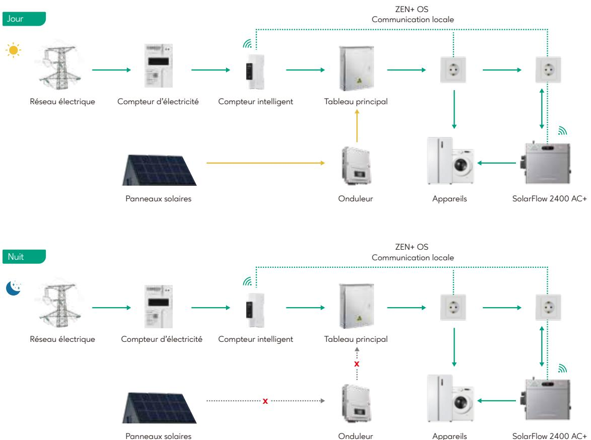
Stockez le surplus solaire le jour et utilisez-le la nuit. Par rapport à l'injection standard via micro-onduleur, le stockage intégré permet d'augmenter fortement le taux d'autoconsommation ( $\geq +60\%$ ), et de maximiser la valeur de votre énergie solaire.
