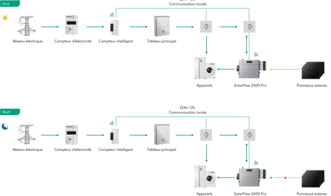
Stockez le surplus solaire le jour et utilisez-le la nuit. Par rapport à l'injection standard via micro-onduleur, le stockage intégré permet d'augmenter fortement le taux d'autoconsommation ( $\geq +60\%$ ), et de maximiser la valeur de votre énergie solaire.
